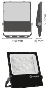
**Technische Daten Ledvance Led-Scheinwerfer Performance 290W 38300lm 60D - 830 | IP66 - Dali Dimmbar - Symmetrisch**
