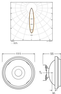
**Technische Daten Ledvance LED spot G53 AR111 11.7W 450lm 40D - 930 | Höchste Farbwiedergabe - Dimmbar - Ersatz für 50W**
