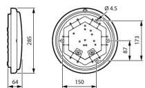
Technische Daten Philips LED-Wand- und Deckenleuchte Ledinaire WL070V Weiß 20.9W 1700lm - 840 | 285mm - IP65 - Bewegungs- und Lichtsensor
